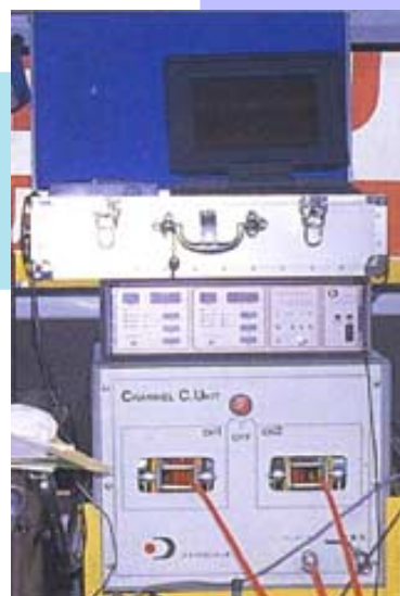
地下タンクの漏洩自動検査装置
